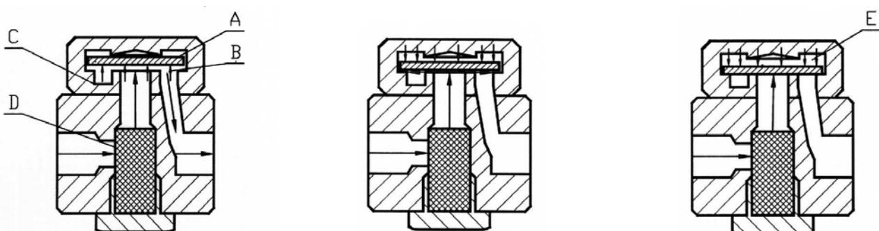
Pločica **A** je podignuta sa sjedišta **C** uslijed tlaka strujanja kondenzata, propuštajući zrak i kondenzat preko filtera **D**, kroz otvor **B**. Kad se pojavi para ona će strujati mnogo većom brzinom, što uvjetuje pad tlaka ispod pločice.
