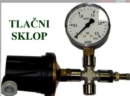
**KNP sustav obilježava jednostavnost pri montaži. Plin se nalazi samo u prostoru dvoplašnog spremnika ili cjevovoda. Pad tlaka se detektira direktno u spremniku, odnosno cjevovodu pomoću tlačnog sklopa. Preko tlačnog sklopa vrši se provjera i jednostavno punjenje inertnim plinom.**
